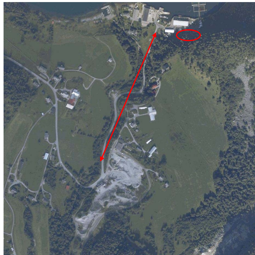
Fig. 5 Ortofoto viser at det er få bygg langs transportvegen (raud pil) og at det er korte avstand mellom dagens masseuttaksområde, som kan nyttast til mellomlagring og knusing av stein, og uttaksområdet til fjellhallane (raud sirkel).
