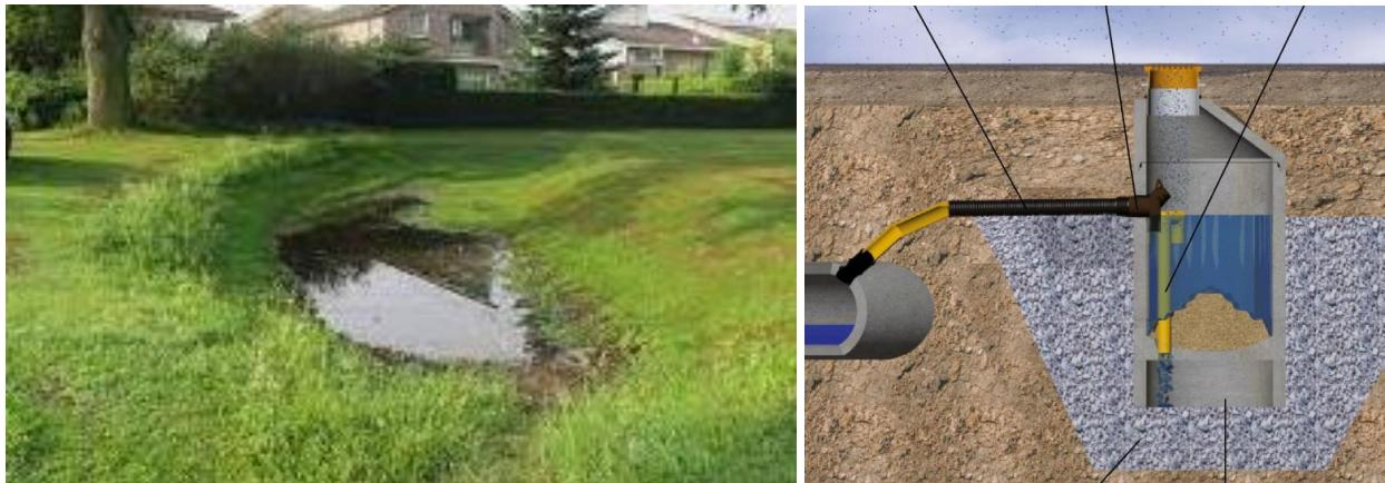
Figur 10 – eksempel på fordrøyning og infiltrasjonsløysing med naturleg basseng og sandfang.
